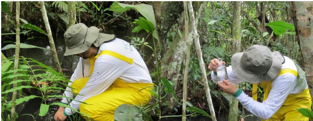
Figura 2-14: Toma de muestra utilizando botellas Winkler para fijación de OD.
