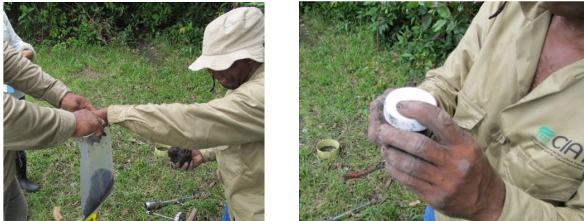
Figura 2-9: Toma de muestras disturbadas y sin disturbar.
