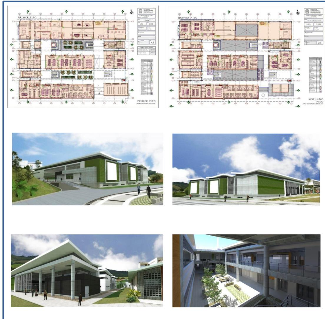
*“Edificio **Bio climático** cuya **estructura** expuesta en **pórticos de concreto reforzado** constituye parte de la **arquitectura** del edificio, dos **patios abiertos lineales** receptores de luz y ventilación natural, incorporan el entorno con el interior “ - (Skyspace - James Turrell).*
