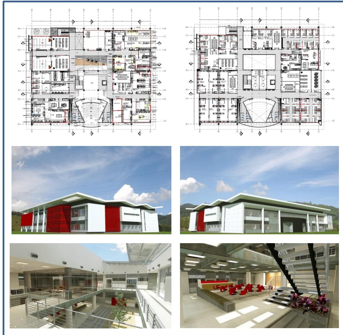
*“Edificio **Bio climático** cuya **estructura** expuesta en **pórticos de concreto reforzado** constituye parte de la **arquitectura** del edificio. Tipología espacial de **patio central abierto** receptor de luz natural, permite soluciones arquitectónicas bioclimáticas*
