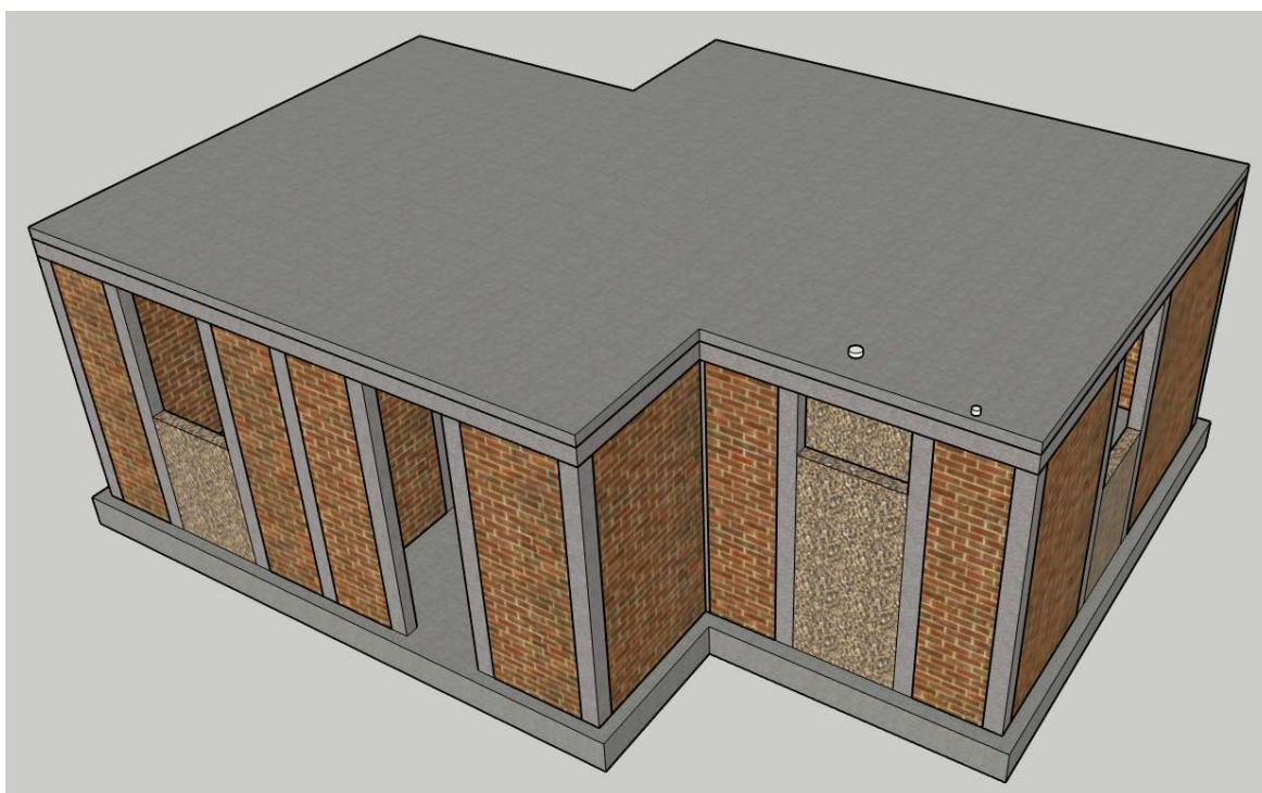
Figura 8-3. Vista de la estructura, placas en concreto y muros en mampostería confinada
