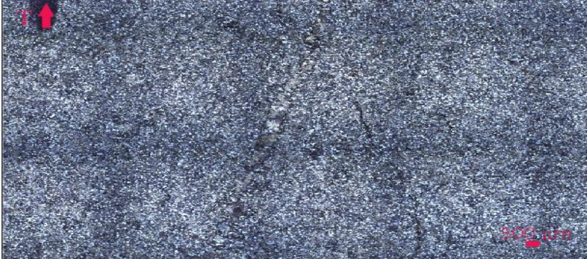
Micrografía, mosaico de la arenita lodosa con fracturas rellenas de carbonato. No se observa laminación. Nícoles paralelos 2X.
