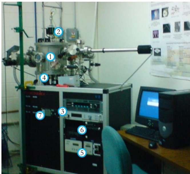
Figura 2.1.1. Equipo de sputtering usado para el crecimiento de las películas delgadas.
