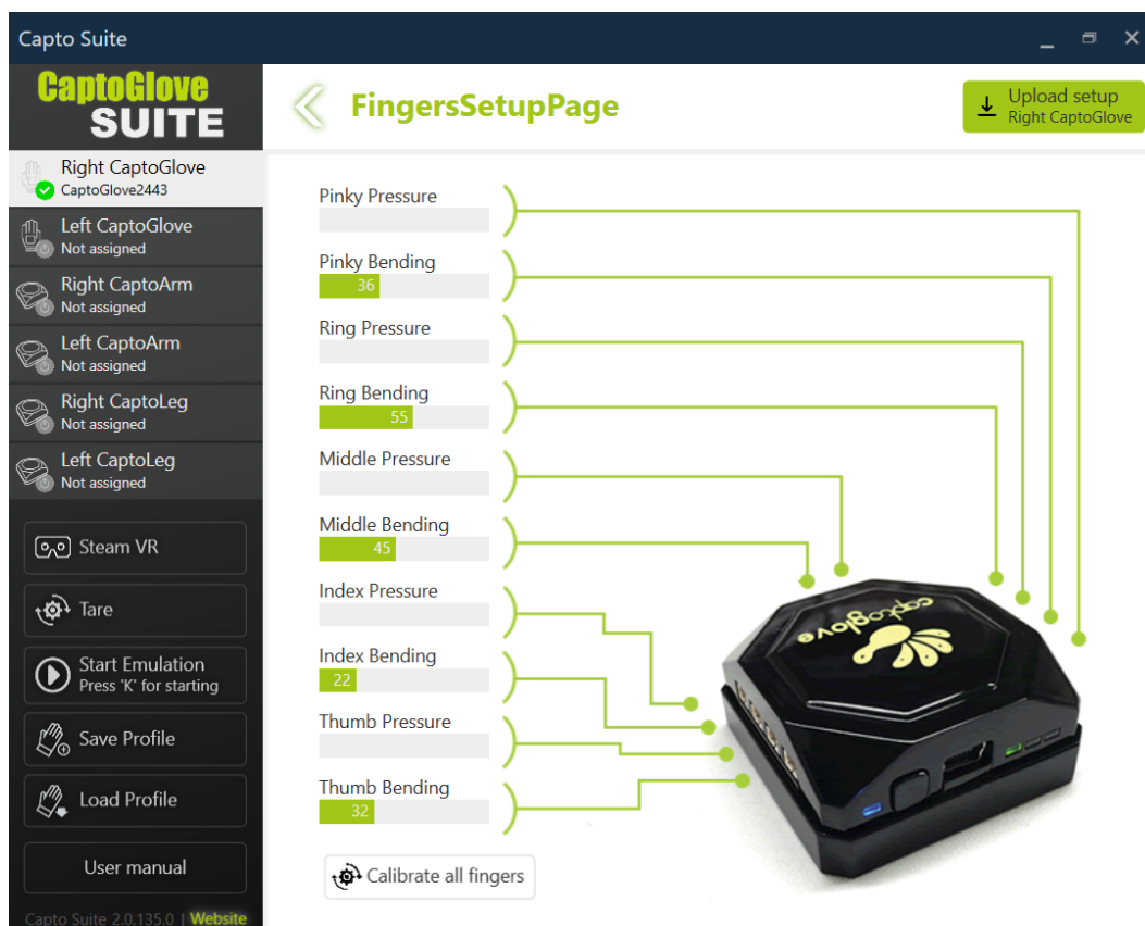
Figura 3-3.: Calibración de flexómetros en CaptoGlove Suite [3]
