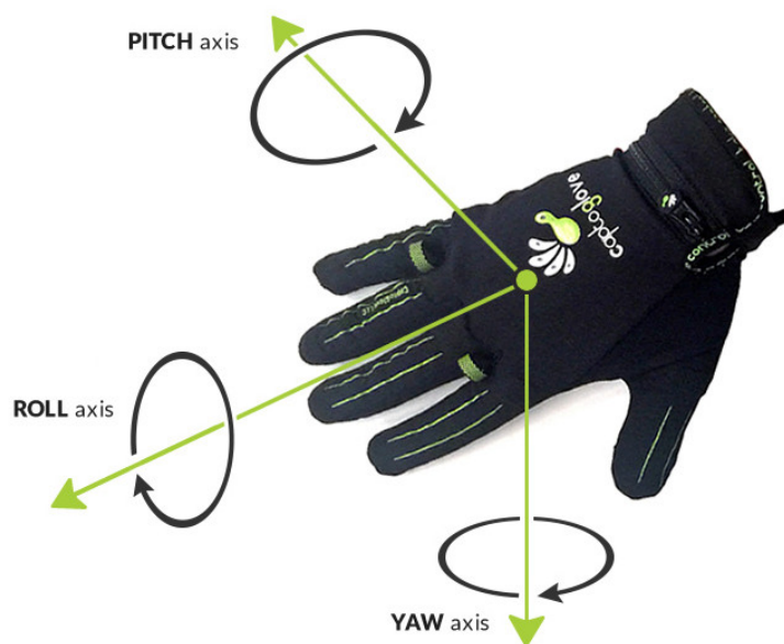
Figura 3-5.: Ejes de rotación CaptoSensor [3]
