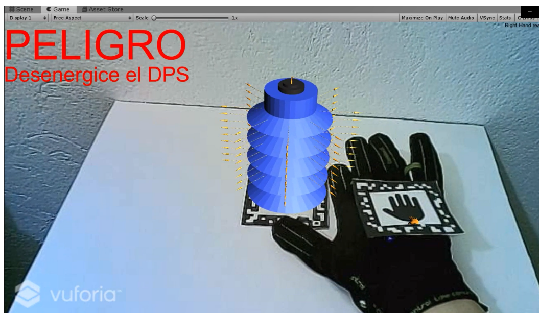
Figura 4-11.: Acercar mano a DPS energizado
