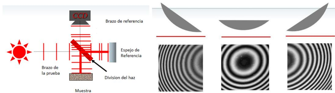
**Figura 2-24** Esquema dispositivo usado en interferencia (derecha), Esquema funcionamiento del interferómetro, variación del plano focal de la lente, contraste del lente según posición (izquierda)[79].
