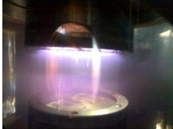
**Figura 2-12** Fotografía Sputtering D.C Ambiente Ar, placa de Ti. (Grupo de películas delgadas P.U.J)
