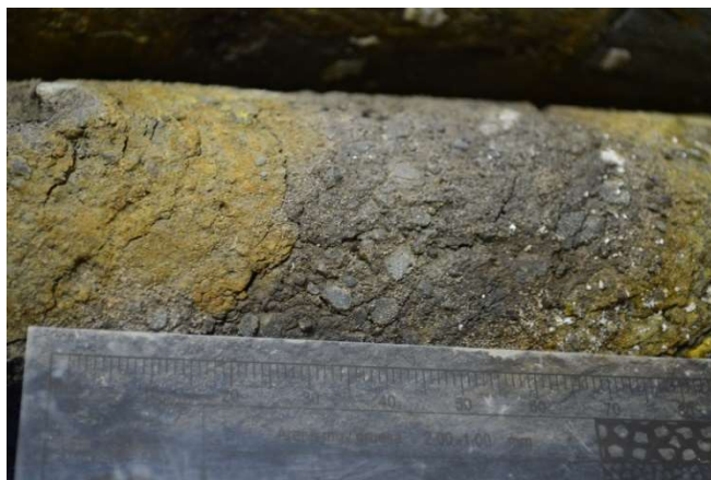
Figura 3-11. Muestra a 518 pies; conglomerado arenoso, clastos angulares de hasta 0,5 cm
