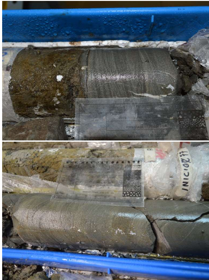
Figura 3-9. Muestra a 769,5 pies arriba y 748 abajo, areniscas cementadas de grano medio con estratificación ondulosa
