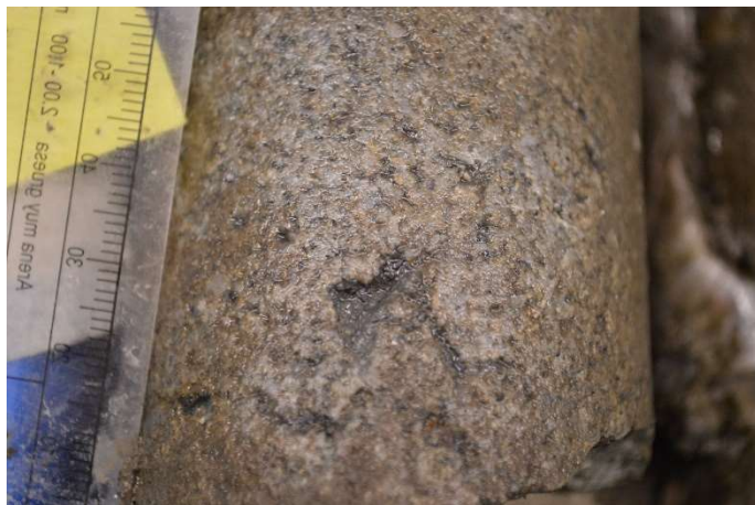
Figura 3-3. Muestra a 1.045 pies, litoarenita feldespática, con granos subredondeados a subangulosos, tamaño arena gruesa, moderadamente seleccionados. Granos: cuarzo monocristalino (Qm), cuarzo policristalino, líticos plutónicos, metamórficos (cuarcita y esquisto, LmS), chert, plagioclasas (Pl) y otros líticos
