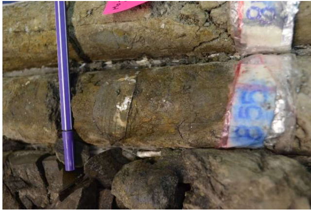
Figura 3-6. Muestra a 854,5 pies, arenisca de grano medio con intraclastos angulares de hasta 10 cm, en la figura se observa un intraclasto de lodolita con laminación plano-paralela
