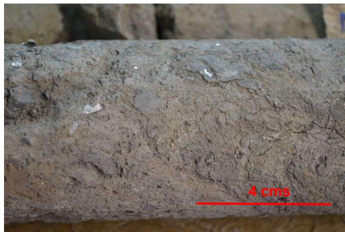
Figura 3-1: Muestra a 1.134 pies, conglomerado arenoso color pardo con clastos angulares. En el núcleo se evidencian cristales de mica moscovita
