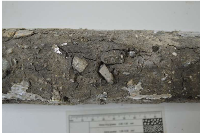
Figura 3-2. Muestra a 1.051 pies, conglomerado arenoso con clastos angulares, de hasta 2 cm, compuestos por lodolitas
