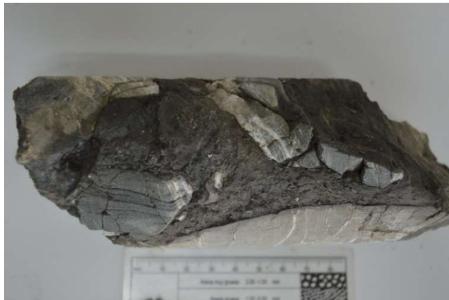
Figura 3-13. Muestra a 292,5 pies; conglomerado clastosoportado con matriz arenosa. Los clastos son de tamaños de hasta 15 cm, y se componen principalmente de lodolitas
