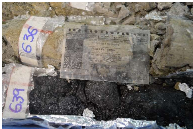
Figura 3-10. Muestra a 639 pies, areniscas grano grueso con impregnación de hidrocarburo en los espacios vacíos
