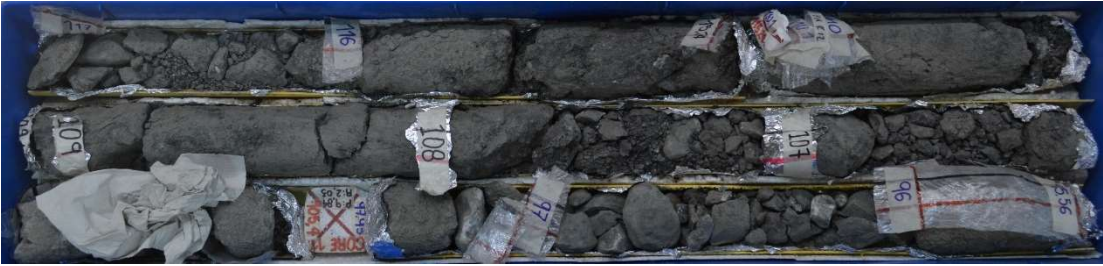
Figura 3-14. Corazones a profundidades de 95,5 pies a 117 pies; lodolita silíceo, gris oscura
