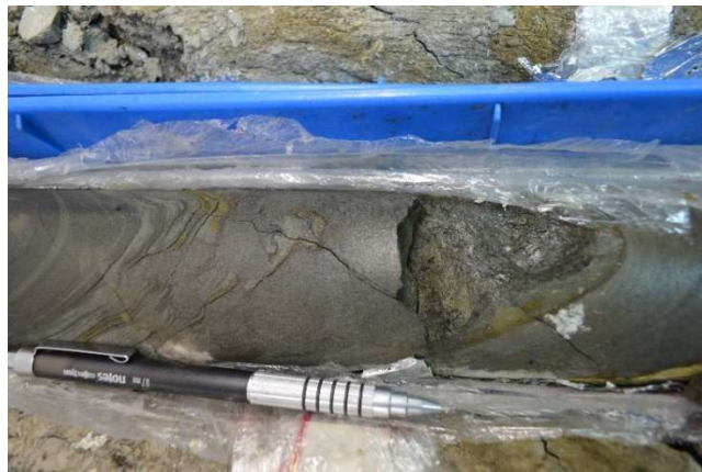
Figura 3-7. Muestra a 830,5 pies, areniscas de grano fino con laminación plano-paralela, afectadas por estratificación convoluta
