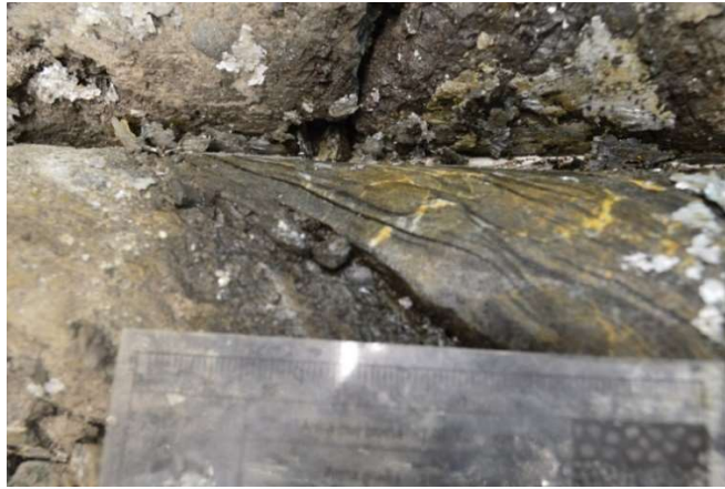
Figura 3-12. Muestra a 457,8 pies; estructura gravitacional “slump” posdeposicional con estratificación convoluta
