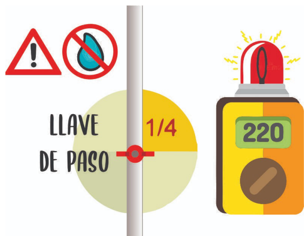
Figura 27. Abrir la llave de paso sólo \frac{1}{4} y verificar el voltaje. Fuente: Propia.
