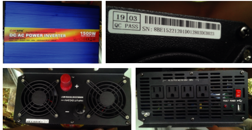
Figura 8. Detalles del inversor del Águila Solar. Fuente: Propia.
