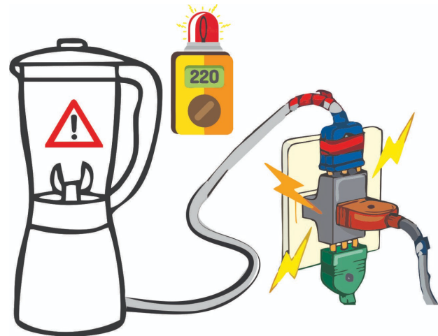
Figura 28. No sobre cargar el sistema, conectando demasiados aparatos electrónicos. Fuente: Propia.
