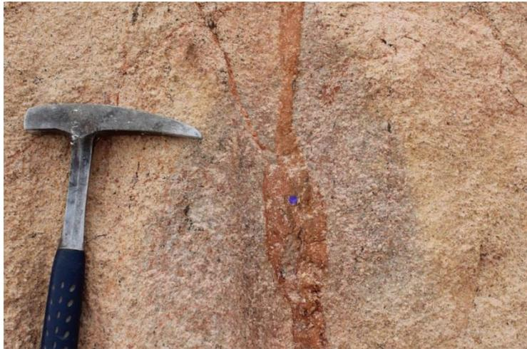
**Figura 6-44:** Detalle del material arcilloso relleno de fracturas en el domo SE - Alto de los Godos. El punto azul marca el sitio de muestreo.
