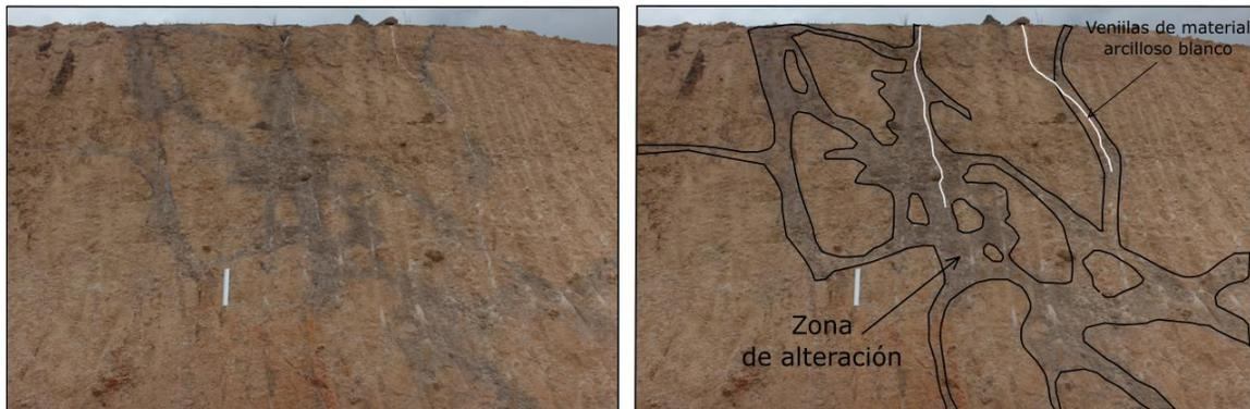
**Figura 6-57:** Detalle en zonas de alteración alrededor fracturas, venas rellenas de material arcilloso color blanco del domo SE - Alto de los Godos. Escala: 1:20.
