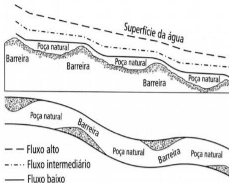
Figura 2-1. Perfil Longitudinal de un río y sus componentes
