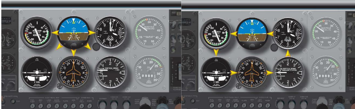
Figura 3-1: Técnica de Chequeo cruzado de instrumentos radial y rectangular
