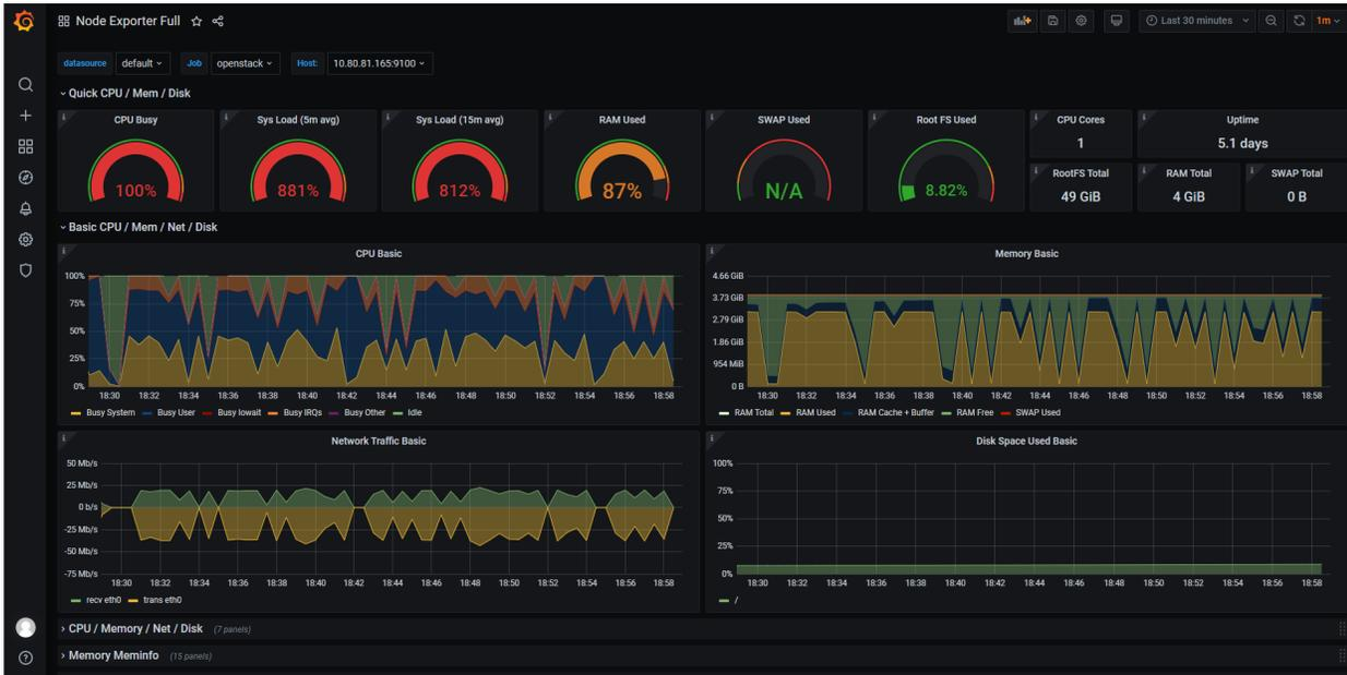
Figura 4-3.: Comportamiento de los recursos del servidor cuando es estresado usando `ab` y `stress-ng`.
