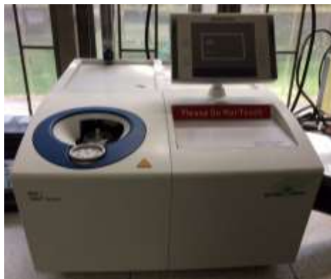
Figura 1- 4: Equipo de calorimetría diferencial de barrido ubicado en el laboratorio de Polímeros.
