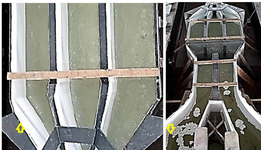
Figura 10-6. Ondulaciones superficiales y vista general de la EEARC. Caudal Medio
