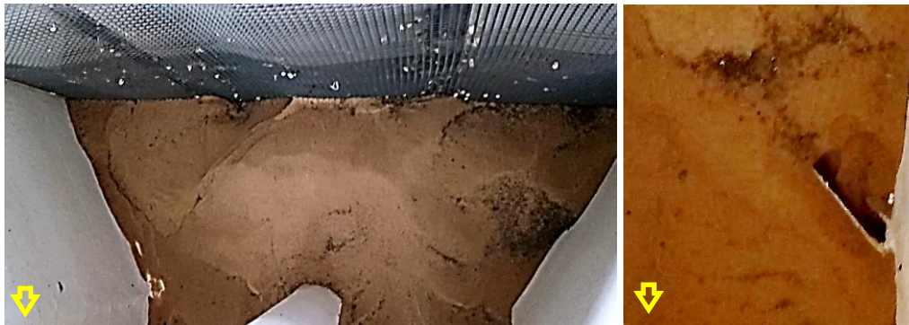
Figura 11-15. Depósito luego de reja de cribado (izq.) y cerca de los excluidores (der.). Caudal Medio y Abastecimiento Alto.
