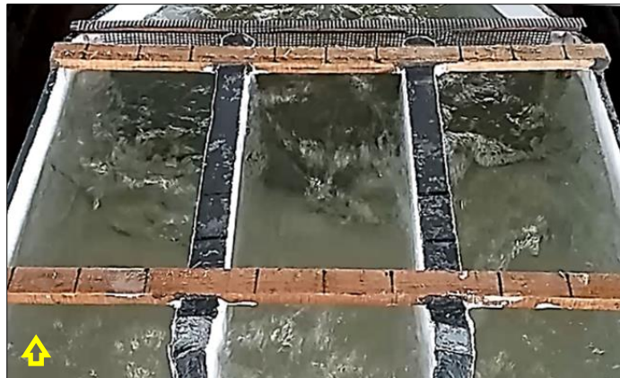
Figura 10-18. Ondulaciones y turbulencia en canales central y laterales. Caudal Máximo
