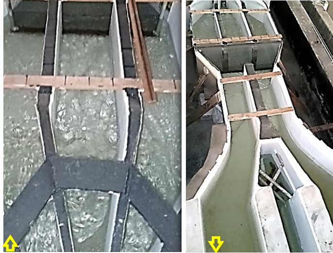
Figura 10-1. Ondulaciones superficiales y turbulencia general EEARC. Caudal Bajo
