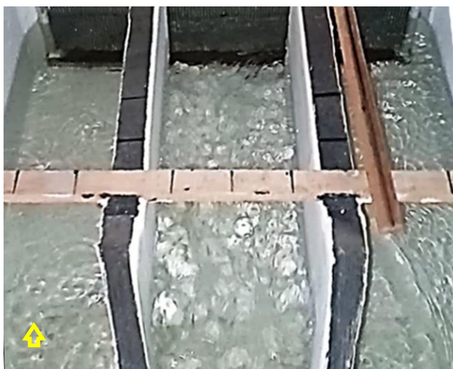
Figura 10-3. Ondulaciones y turbulencia en canales central y laterales. Caudal Bajo
