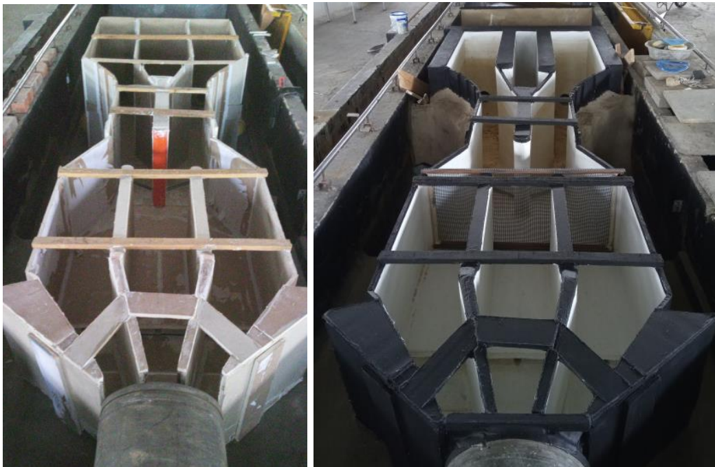
Figura 8-7. Modelo finalizado antes (izq.) y después (der.) de la impermeabilización
