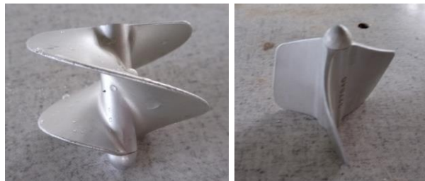
Figura 9-6. Hélice de alta sensibilidad (izq.) y de sensibilidad media (der.)
