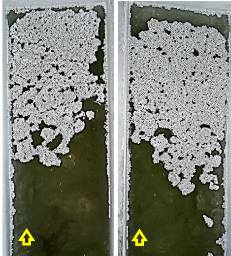
Figura 10-14. Comportamiento general cárcamos de bombeo. Caudal Medio Alto.
