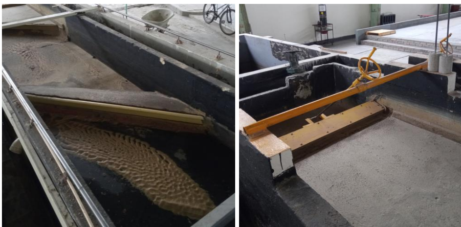
Figura 4-5. Canales de modelación UISA. Exclusor (izq.), compuertas basculantes (der.).
