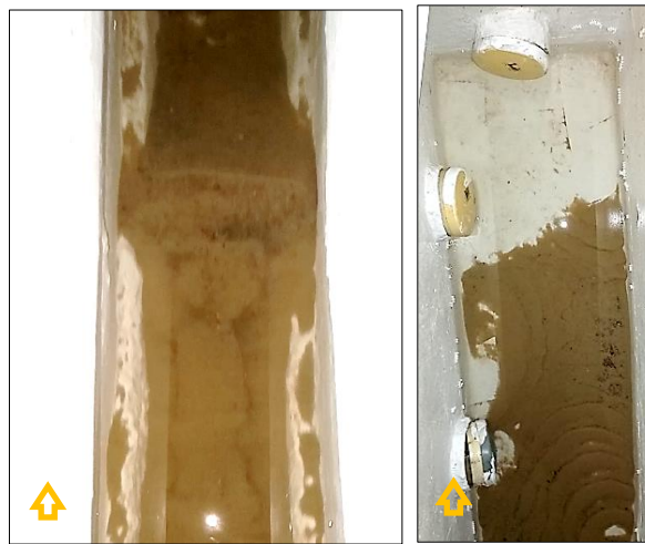
Figura 11-31. Acumulación de sedimentos excluidos (izq.) y cárcamos de bombeo (der.). Caudal Máximo y Abastecimiento Medio
