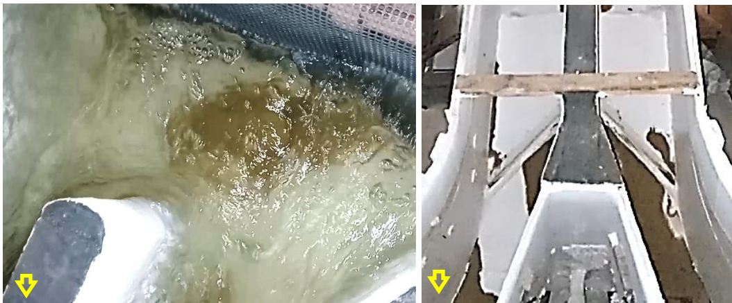
Figura 11-20. Depósito luego de reja de cribado (izq.) y en cercanías a exclusores (der.). Caudal Medio Alto y Abastecimiento Medio
