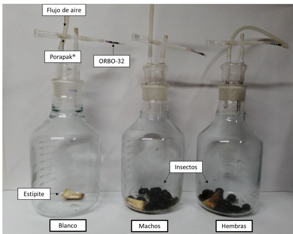
Figura 3-7. Montaje empleado para la extracción de los VOCs liberados por Strategus aloeus mediante HS-MEFS. Foto: V. Vidal-Medina.
