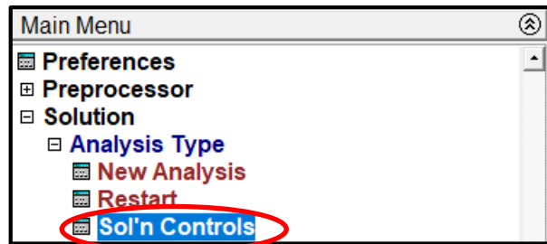
Ilustración 14. Ubicación del comando “solution controls” en ANSYS APDL.
