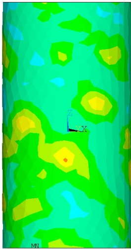
a. Deformación principal mayor \epsilon_1 - Punto 2 de la Figura 7-8
