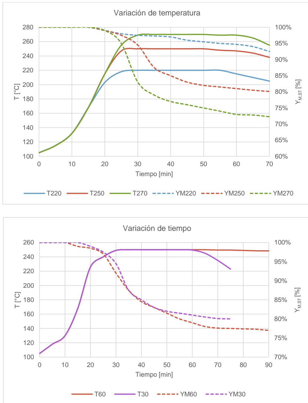
Figura 3-2: Efectos de variación de parámetros para torrefacción de fibra en TGA. a) variación de la temperatura de torrefacción. Donde T220, T250, T270 son las curvas de temperatura de la torrefacción a 220, 250 y 270 °C, respectivamente; YM220, YM250 y YM270 son las curvas de rendimiento másico de la torrefacción a 220, 250 y 270 °C, respectivamente. b) variación del tiempo de torrefacción. Donde T60 y T30 representan las curvas de temperatura con tiempo de retención de 60 y 30 min, respectivamente; YM60 y YM30 son las curvas de rendimiento másico con tiempo de retención de 60 y 30 minutos, respectivamente (gráficas adaptadas de [39]).
