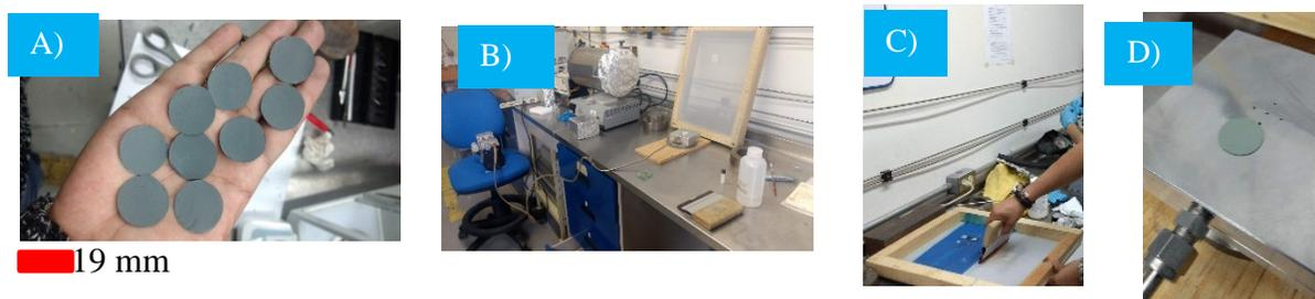
**Figura 18.** A) Corte de las cintas para la formación de los ánodos, diámetro 19.5 mm (Antes), B) ajuste de la malla en el sistema de vacío que sujetara al ánodo al momento de hacer la impresión, C) Proceso de Impresión, con la malla encima del ánodo, para dispersar homogéneamente el material, D) fotografía en la cual se observa la impresión de la capa de Interlayer (Después).
