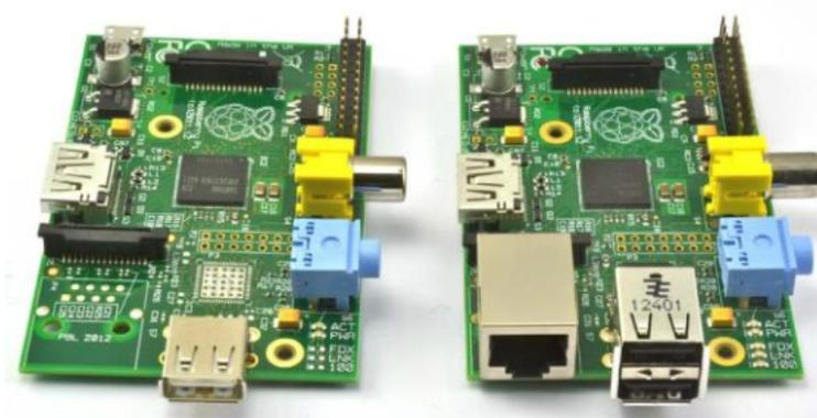
**Figura 2-2.:** Placa Raspberry Pi modelo A (izquierda) y modelo B (derecha)[54].
