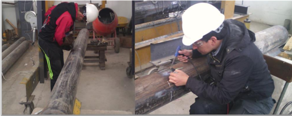
Figura 2-17: Proceso de instalación de las galgas
