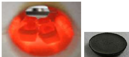
Figura 3-32: Muestras en horno tubular a 850 °C y muestra final sintetizada a 1250 °C. (Autor)
