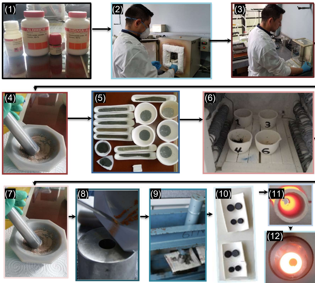
Figura 2-3: Proceso usado en el laboratorio para la síntesis por el método de reacción de estado sólido. (Autor).
