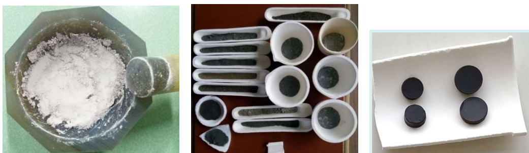
Figura 3-1: Fases inicial, intermedia y final, durante la síntesis de las muestras del tipo \text{Sr}_y\text{R}_{1-y}\text{Ti}_y\text{Mn}_z\text{Fe}_{1-y-z}\text{O}_{12} . (Autor)
