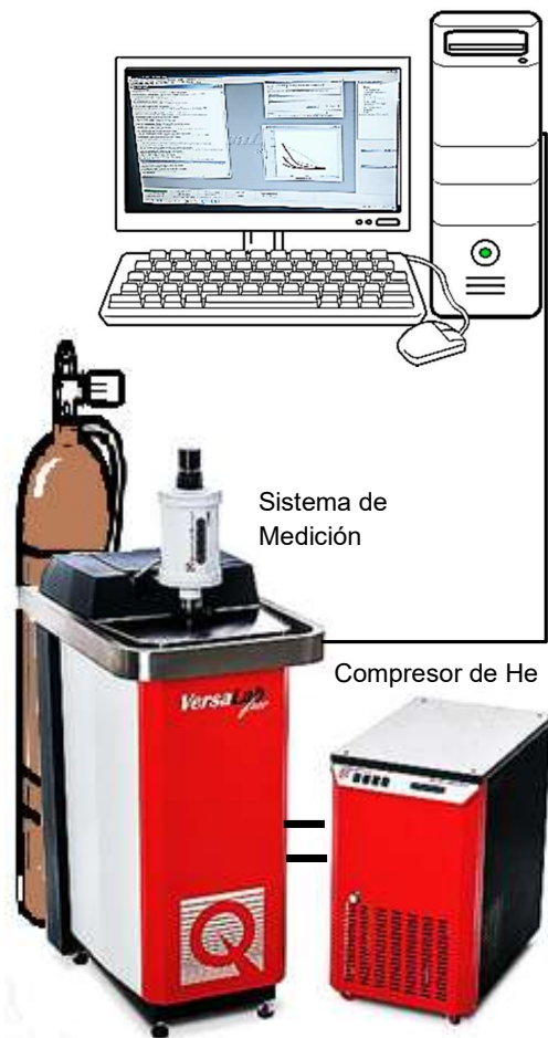
Figura 2-23: Magnetómetro de muestra vibrante (VSM) VersaLab Quantum Design SQUID (Escuela de Física-UPTC). (modificado de https://www.qdusa.com/ )
