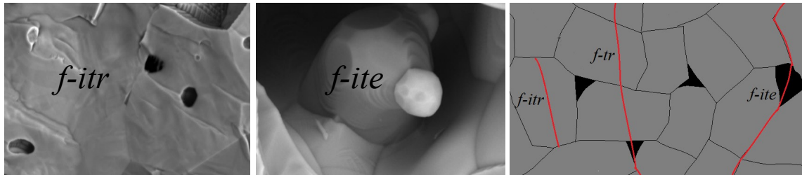
Figura 2-18: Micrografías con fractura intragranular e intergranular y esquema con los tres tipos de fractura (líneas rojas). (Autor)
