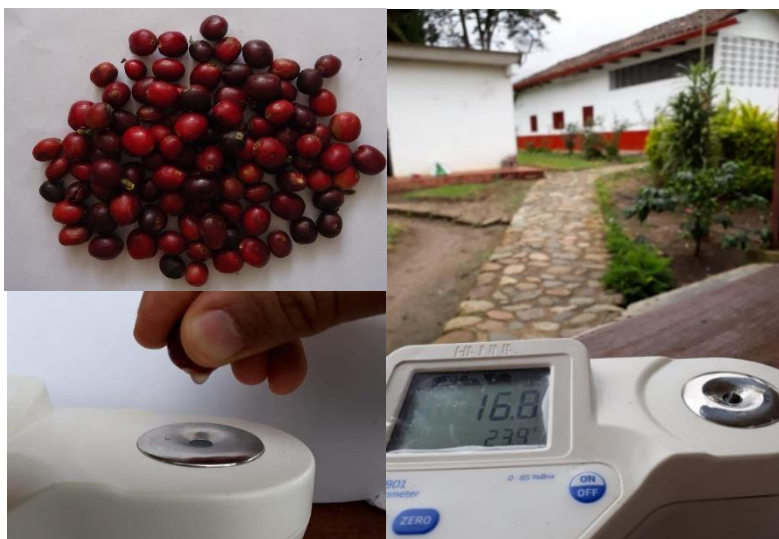
Figura 3-2. Proceso de medición Brix en cereza
