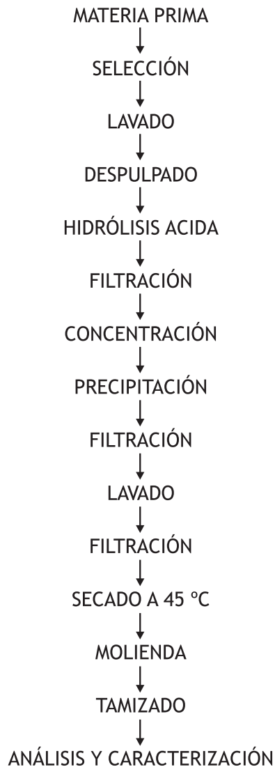
Figura 11. Diagrama de proceso para la obtención de pectinas de uchuva ( Physalis peruviana ).
