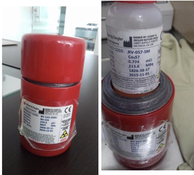
(a) Contenedor de fuente. (b) Fuente radiactiva sólida tipo gotero.
