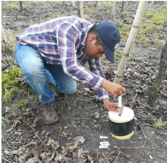
Ilustración 2-3 Muestreo de gases en cámara estática en campo.
