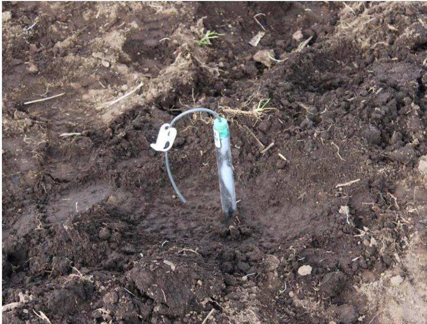
**Figura 4.1** Instalación de lisímetros de succión.
