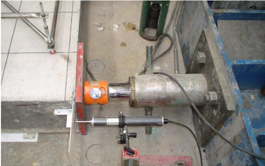
*Figura 17: Aplicación de carga lateral a los modelos.*
