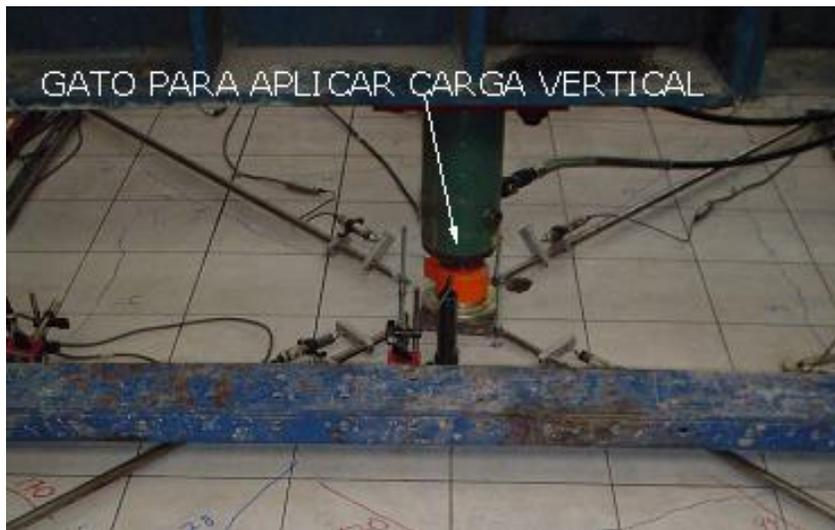
Figura 16: Aplicación de carga vertical a los modelos.
