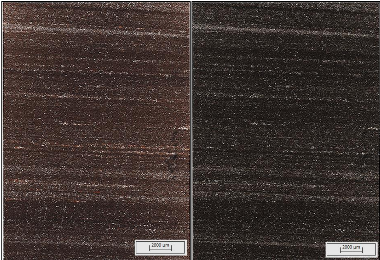
Sección SA-1926 de "Aico Shale". Arcillolita micrítica, fosilífera, rica en materia orgánica. Laminación plana paralela continua a discontinua. Se presentan pequeños lentes paralelos con la laminación.
