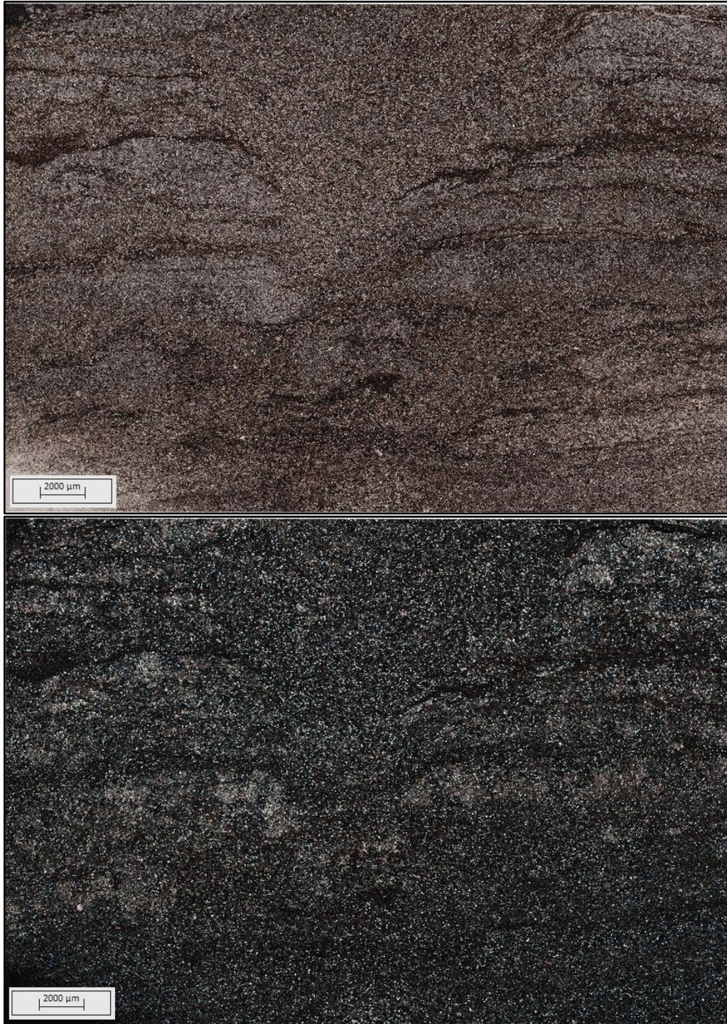
Sección SA-1947 de la Formación Buscavida. Arenita limosa de grano muy fino, litoarenita, fosilífera, con cemento calcáreo, rica en líticos volcánicos, con láminas de lodolita; rica en materia orgánica. Laminación ondulosa paralela a no paralela discontinua. Hay posibles estructuras de madrigueras verticales (al medio) que interrumpen la laminación.
