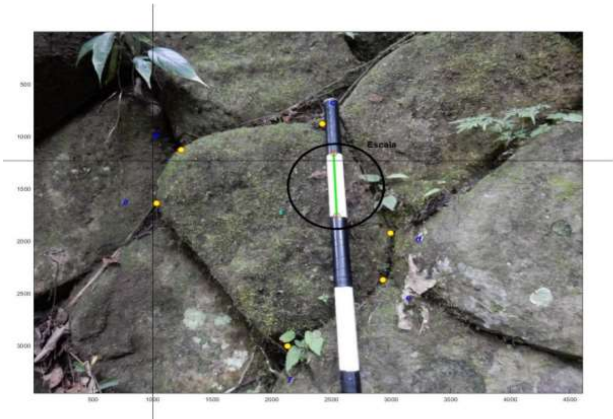
Figura 3.2. Fotografía de un afloramiento en la cual, un objeto de dimensión conocida (tubo con divisiones decimétricas), es usado para determinar la escala de elementos de la imagen (línea verde creada automáticamente por el programa). Los círculos amarillos son marcas definidas por el usuario para señalar los vértices en los polígonos de las columnas.
