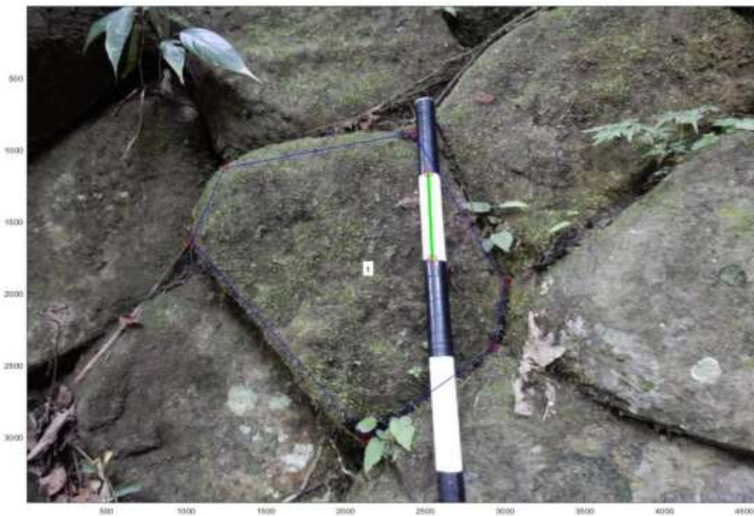
Figura 3.3. Polígono trazado (líneas azules) por el software para el cálculo de las longitudes de los lados y del área incluida.
