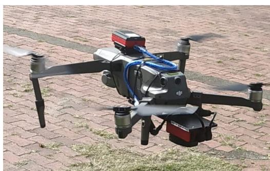
Figura 4-2: Mavic Pro equipado con la cámara multispectral Parrot Sequoia.
