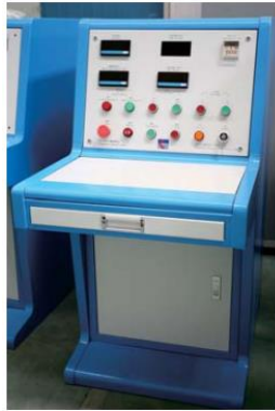
Ilustración 2-24. Pupitre de control Yangzhou Power Electric Co.
