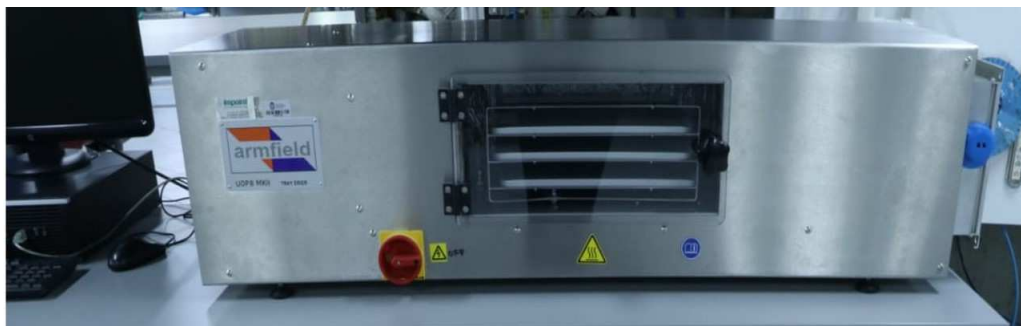
FIGURA 3.1. Secador de bandejas instalado en laboratorio.
