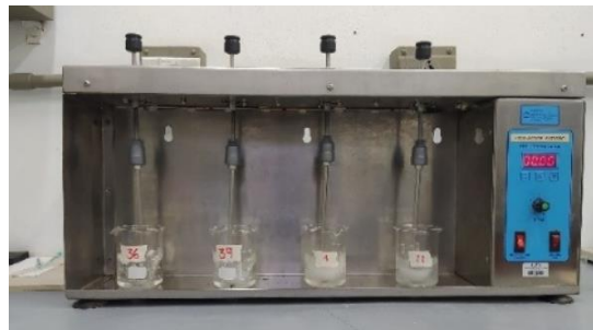
Figura 2-4: Montaje experimental pruebas de cianuración.
