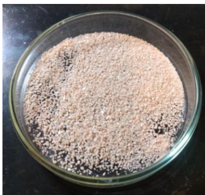
Figura 2-4: Muestra mineral para flotación espumante. Tamaño de la muestra +850 \mu\text{m} (20 mallas ASTM).
