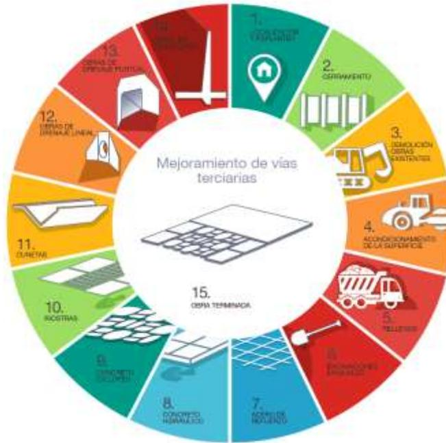
Ilustración 5. Proceso constructivo vías terciarias.
