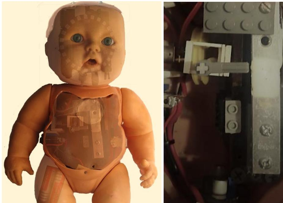
**Figura 5-2** (a) Prototipo completo, (b) Accionamiento movimiento torácico y celda de carga
