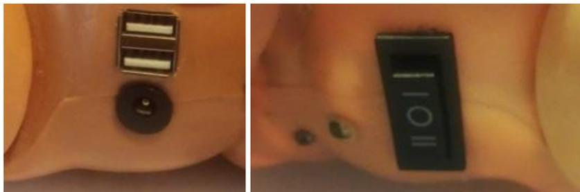
**Figura 5-3** Conector de carga para baterías, Puertos USB, Interruptor de encendido
