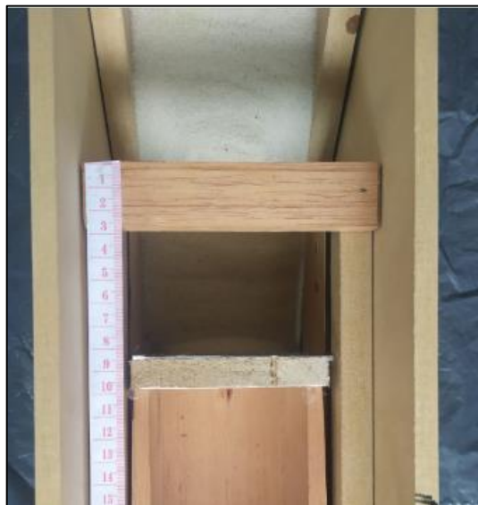
Ilustración 3.1.3: Medición y tabulación del movimiento que generó el deslizamiento en la estructura.
