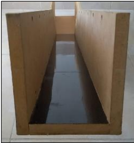
Ilustración 3.1.3.2-3: Rampa de deslizamiento del material.
