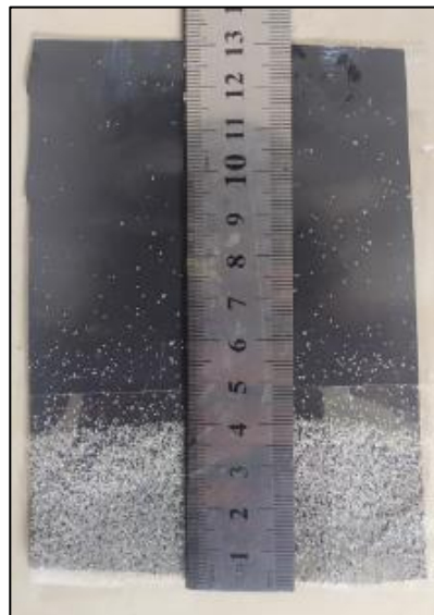
Ilustración 3.1.3.2-5: Medición de la traza que dejó el deslizamiento en la estructura
