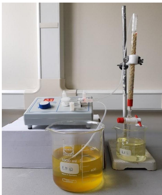
Figura 2.1. Montaje experimental para la evaluación de parámetros en la adsorción de Cr(VI) en una columna de lecho empacado.
