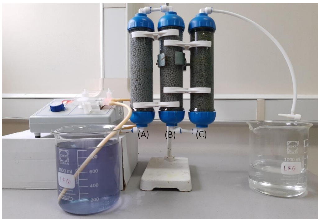
Figura 3.20. Montaje experimental para la adsorción de Cr(III) y Cr(VI) en ARnD proveniente de industria de curtiembre. (A) y (B) filtros de compósitos de Bent-Na(2%)/Alg, (C) filtro de compósitos OB-HDTMA(2%)/Alg.
