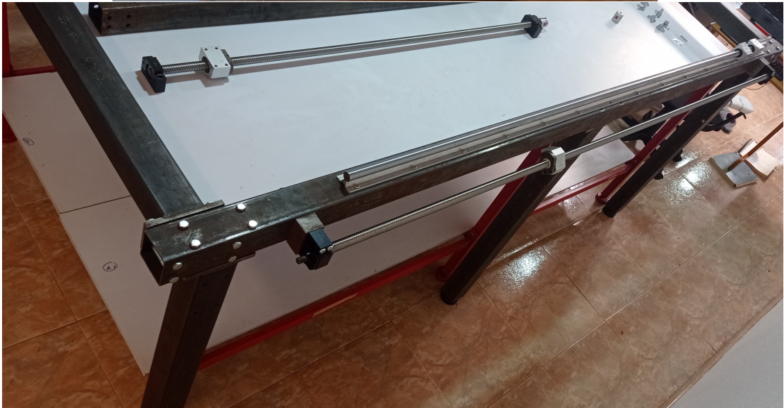
Figura A.4: Detalle de la longitud de la guía lineal y tornillo de bolas para articulación q_1 con respecto los mismos elementos más cortos destinados para q_2 .
