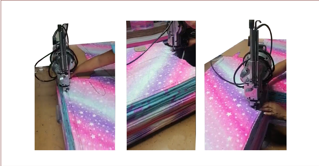
Figura 7.12: Máxima capacidad de corte de la tela considerando un tendido multicapa.
