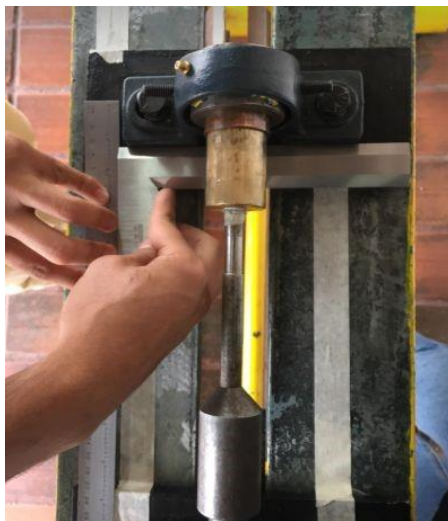
Figura 162. perpendicularidad del cojinete de arco central, con ayuda de líneas guía marcadas anteriormente.
