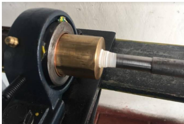
Figura 103 Cruceta conectora del subsistema de trabajo con el subsistema de transmisión de potencia.
