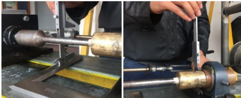
Figura 168. Toma de medidas de alturas de los componentes respecto a la bancada.
