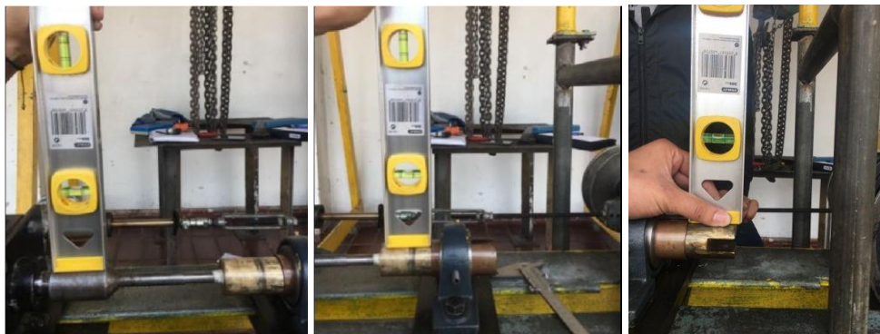
Figura 167. verificación de nivel de los componentes (debe tener el mismo nivel del cilindro).
