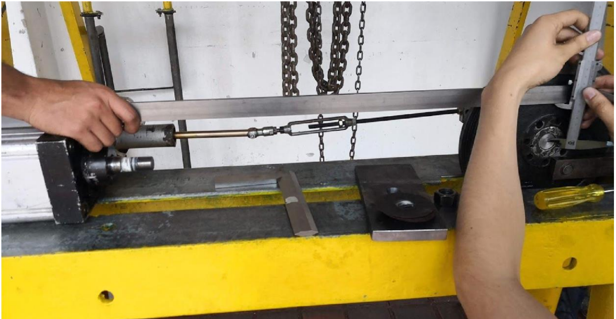
Figura 171. verificación de altura del eje, en la posición del volante, para garantizar alineación con el resto del mecanismo.
