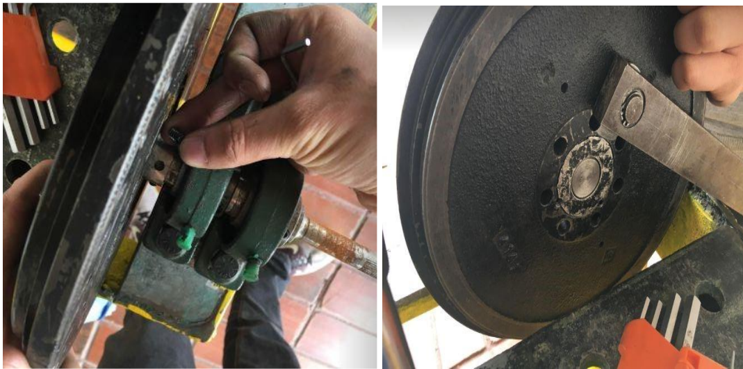
Figura 170. Alineación de volante de inercia.
