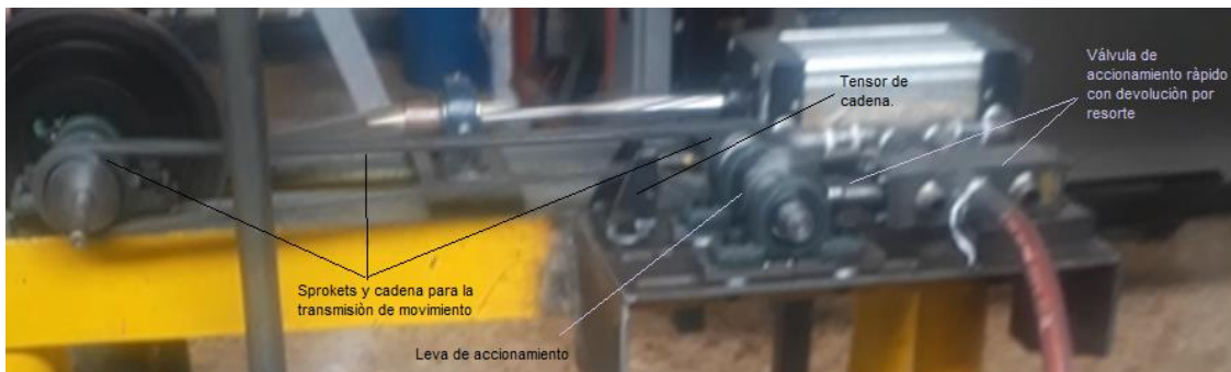
Figura 79. Sistema de distribución de corte rápido.
