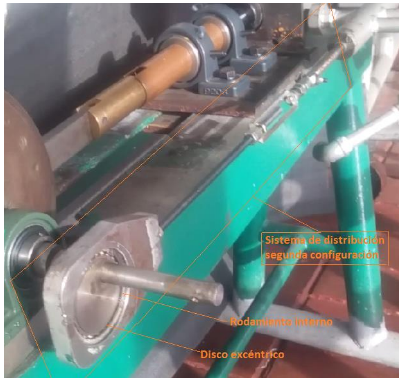
Figura 101 Sistema de distribución MDV segunda configuración tipo rodamiento excéntrico.
