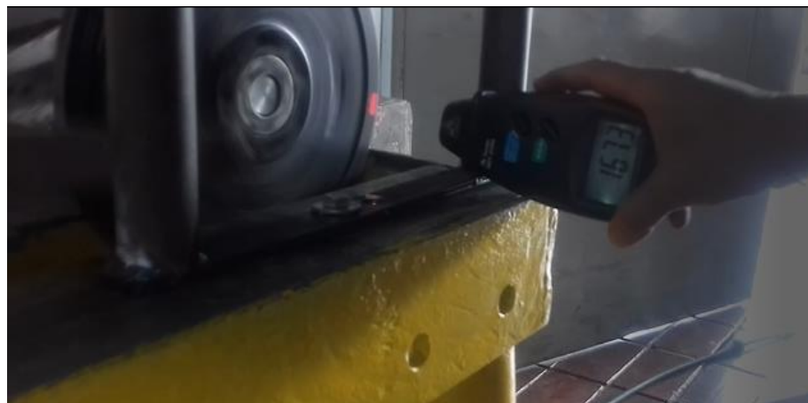
Figura 76. Medición de velocidad rotacional en el eje de salida del motor de vapor.
