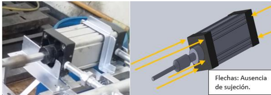
Figura 92. a) Pistón y vástago del sistema mono cilíndrico primera versión y b) CAD del pistón con puntos de sujeción realizado en software solid works.
