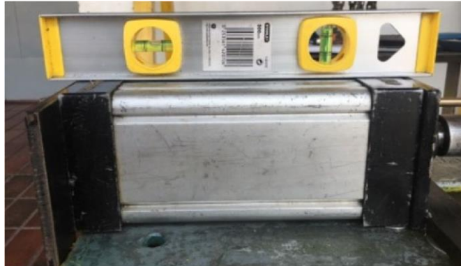
Figura 158. Nivelación del cilindro.
