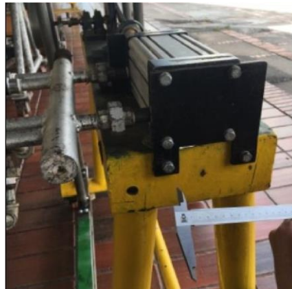
Figura 156. Ajuste placa soporte cilindro de referencia.
