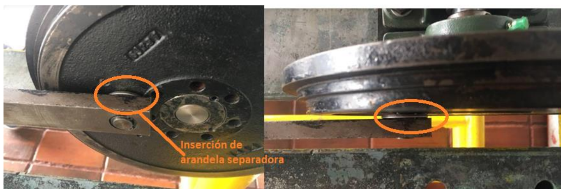
Figura 104 Colocación de arandela de separación para evitar la fricción en el subsistema de transmisión de potencia.
