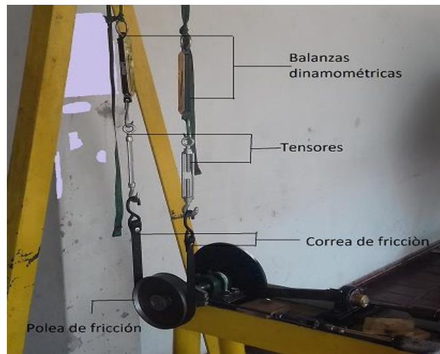
Figura 98 Instalación versión 1 freno Prony de fricción.
