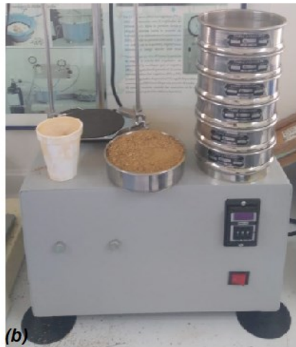
Figura 22. (a) Disposición de material en Icopor, (b) Tamizadora electrónica, (c) Pesaje 1 del material. Elaboración propia
