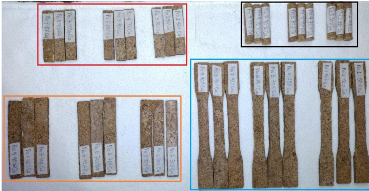
Figura 28. Probetas de Tensión (Color Azul), Flexión (Color Naranja), Impacto (Color Rojo) y Compresión (color negro). Elaboración propia
