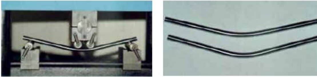
Figura 13. Ensayo de Flexión. Izquierda: Disposición equipo VS material. Derecha: Resultado final del ensayo. Tomado de [27]
