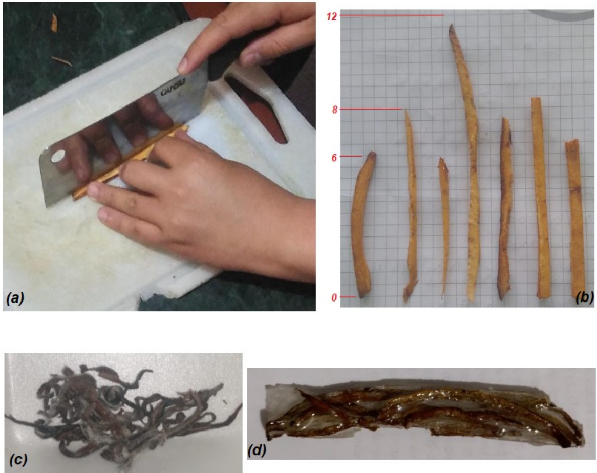
Figura 18. (a) Proceso de corte, (b) tirillas de Cacao, (c) Presencia de hongos y (d) Fabricación de la probeta. Elaboración propia
