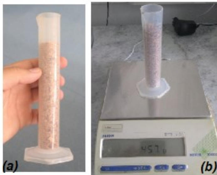
Figura 23. (a) Probeta con partículas de cacao, (b) Pesaje en balanza electrónica. Elaboración propia
