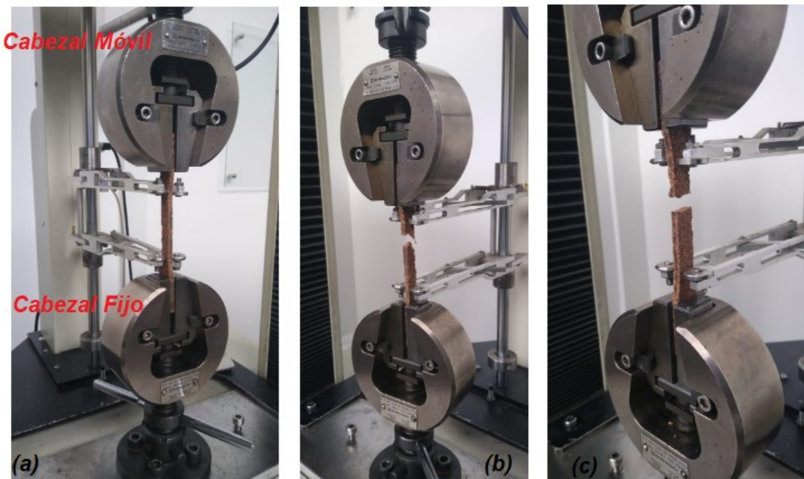
Figura 29. (a) Probeta sin Romper, (b) y (c) Probeta después de aplicada la fuerza. Elaboración propia (Tensión)
