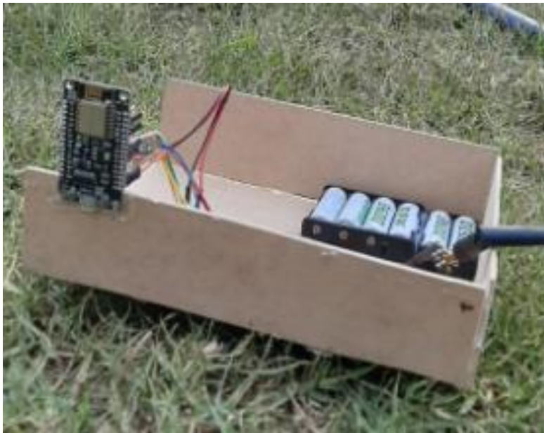
Figura 3-4: Gateway desplegado y en funcionamiento
