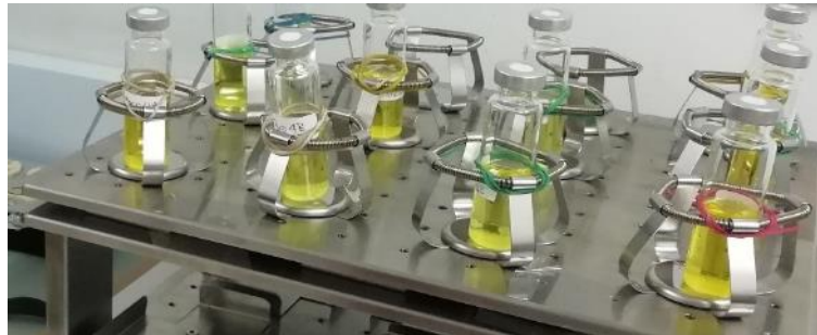
Figura 4-8: Viales en agitación para recuperar los reactivos y la muestra de la silica gel
