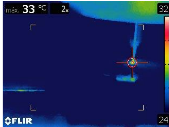
Figura 2-21: Termograma del proceso de micro-fresado plano – probeta DRX
