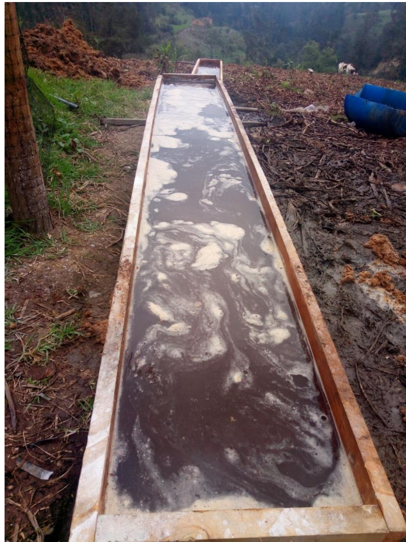
Figura 3-5. Estructura para lavado de almidón de achira.
