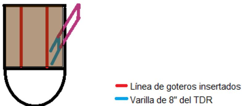
**Figura 3.** Lado izquierdo del esquema de inserción de la varilla del medidor de humedad TDR 350 Soil Moisture Meter Inc en el sustrato. Lado derecho ilustración del equipo de medición.
