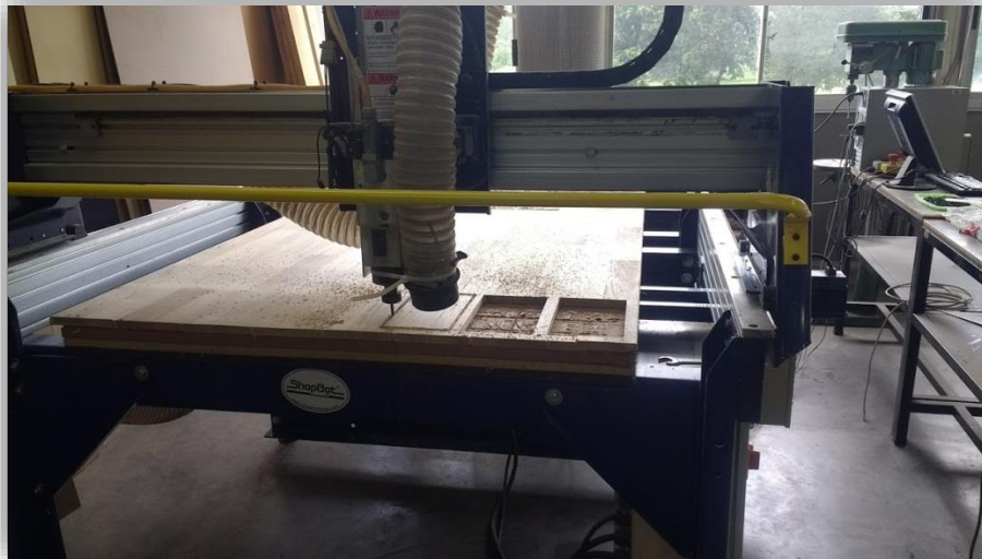
Figura 6. Corte de las partes de la colmena de observación en el Laboratorio de Fabricación (FabLab) de la Universidad Nacional de Colombia sede – Medellín.
