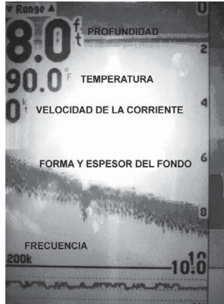
Figura 201. Apariencia de la interfase del sonar GARMIN fishfinder 340c en el cual se observan los datos básicos utilizados en este estudio.
