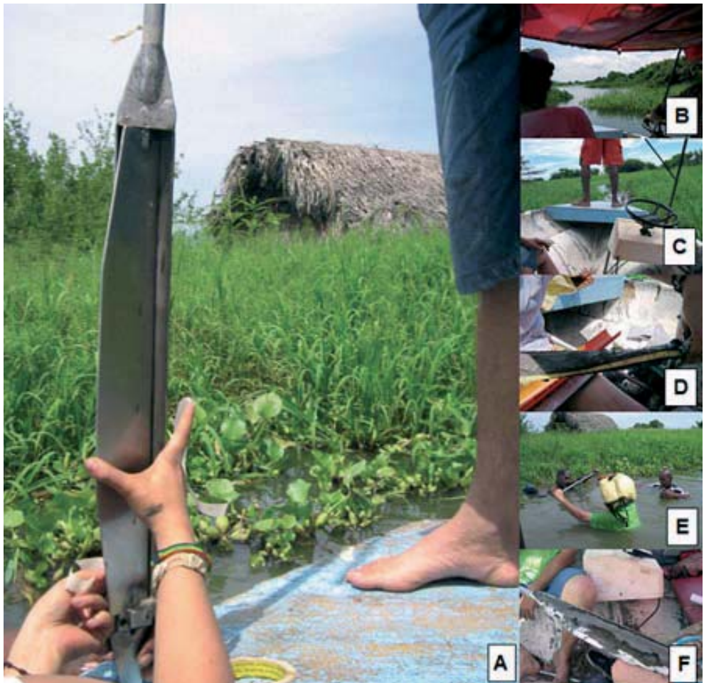
Figura 90. Proceso de extracción de una columna de sedimento.
