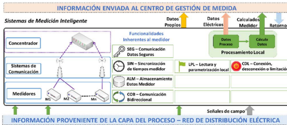
Figura 4-6.: Componentes de un sistema de medición inteligente [68]
